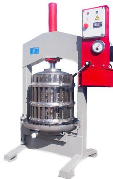
Уважаемый покупатель! Вы приобрели пресс OPREMA 40I электрогидравлический 68 л для извлечения сока из ягодной, фруктовой, овощной мезги.
