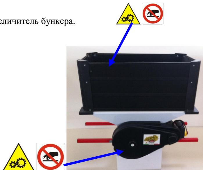
**Рис. 2. Опасные движущиеся механизмы**
